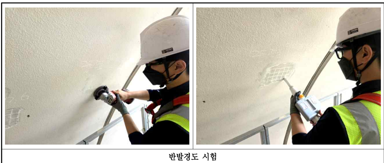
【사진 2.4.1】 강도시험 현장사진
