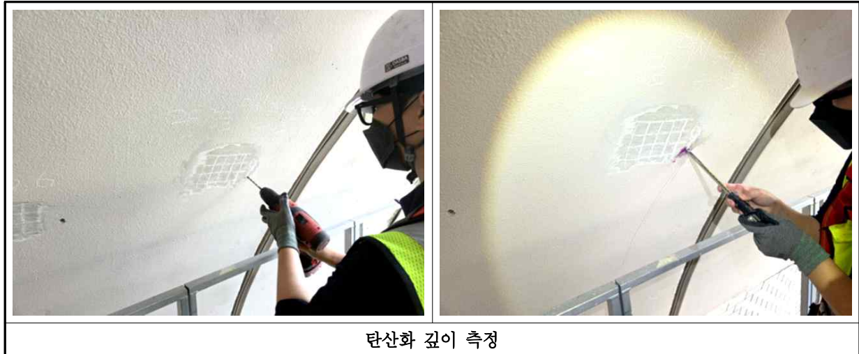
【사진 2.4.2】 탄산화 깊이 시험 현장사진
